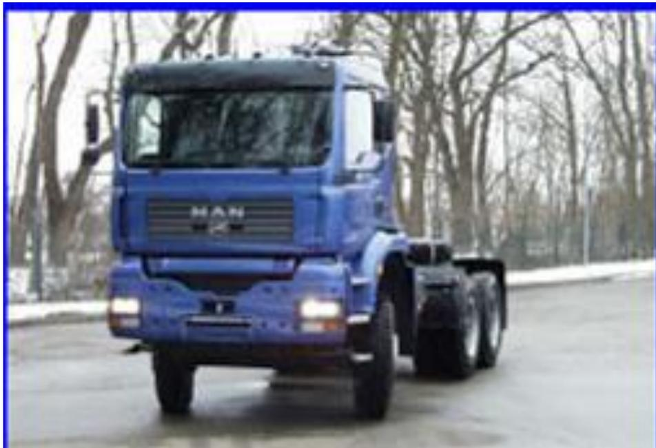
In tutti i veicoli a trazione integrale tradizionale 4x4 e 6x6: l'altezza del filo telaio e del piano ralla da terra è ALTA ovvero circa 55 mm più alta rispetto ai veicoli 4x2 o 6x4 altezza media e ai corrispondenti Hydrodrive.
