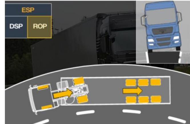
Bremsen aller Räder bei drohendem Umkippen des Fahrzeugs
